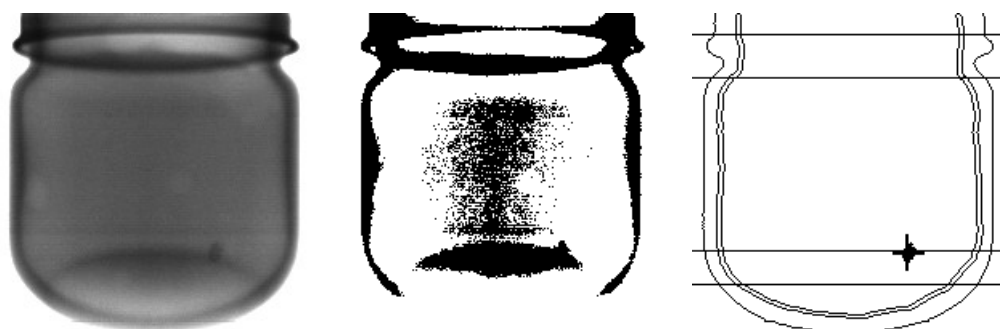
Figura 4 - Nel caso di una geometria più complessa come quella di un vasetto di omogeneizzati i criteri di discriminazione basati sulla sogliatura non sono praticamente di nessuna utilità, bisogna avvalersi di algoritmi più sofisticati.
